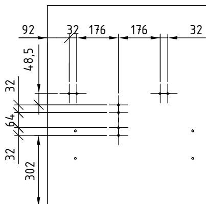
2. Вариант установки полки слева
